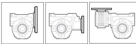
Le tabelle per la selezione riduttori possono essere utilizzate anche per i riduttori nella configurazione P (predisposti per attacco motore IEC B5 o B14).
